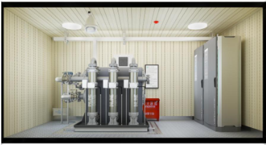
无须设专门泵房，节省基建资金及用地，整体泵房为可移动式结构，集成化程度高；四重安全保护措施，相互联动控制，达到反恐级别；施工简便，安装周期短，设备就位后1h内即可通水；模块式箱体泵房，隔热保温、防雷降噪，内设温湿度保护系统，保障泵房可在室外-30℃~50℃的温度范围内正常运行；泵房设远程监控系统，可通过无线或有线网络接入水司智慧管理平台，及时准确实现无人值守功能；智能化程度高，无人值守，自动运行；泵房溢水报警系统：通过安装有我司泵房溢水报警系统，实时监测被监控区域的漏液情况，监控系统能根据告警配置提供LED屏、声音、短信等多种报警方式，并及时通知维护人员现场漏水的故障情况，保证告警得到及时处理。同时监控系统也能根据告警情况自动实现相应的逻辑控制如停泵、停水，保证故障得到消除和减小故障带来的损失；多功能水质在线检测可对水中余氯、浊度
