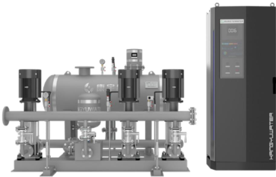
变频供水设备是一种新式的节能供水设备。变频供水设备系运用当今先进的微电脑操控技能，将变频调速器与电机水泵组合而成的机电一体化高科技节能供水设备。变频供水设备以水泵出水端水压（或用户用水流量）为设定参数，经过微机主动操控变频器的输出频率然后调理水泵电机的转速，完成用户管网水压的闭环调理，使供水体系主动恒稳于设定的压力值：即用水量添加时，频率进步，水泵转速加速；用水量削减时，频率下降，水泵转速减慢。这样就确保了整个用户管网随时都有足够的水压（与用户设定的压力共同）和水量（随用户的用水状况改变而改变）多功能一体阀：将止回阀和蝶阀巧妙地集成于一体，省去两者之间的连接件。南京康宇制造
