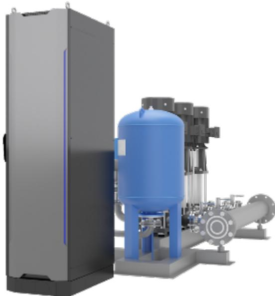
ZDL系列设备主要由多联控制系统、稳流补偿系统、全变频增压系统、多功能底座系统四大部分组成。以大数据平台运维为支撑，实现了工业互联、智能运维和智慧供水，多罐式集成、全变频技术、全流量覆盖，安全程度高、节能效果。设备分为I型和II型。I型为三罐式设计II型为双罐式设计，二者均可选择Inlinedelta静音泵或立式离心泵作为动力。应用范围：●新建的高层(小高层)住宅小区、办公楼、宾馆、学校等建筑的生活用水；●原有气压式、水池、水箱式给水设备的改造工程。标准产品主要性能参数：●流量范围0-1000m<sup>3</sup>/h●压力范围：●压力调节精度：≤●电机单机容量：≤●电源380V±10%50Hz±5%●温度：0~+40℃●湿度：可在潮湿环境下运行●环境：室内无腐蚀性、无油雾、无导电尘埃型号意义I型三罐式集成设计、全变频技术、全流量覆盖，安全程度高、节能效果II型两罐式集成设计、全变频技术、全流量覆盖，安全程度高、节能效果。南京康宇制造相比罐式管网叠压（无负压）给水设备调蓄能力提高，同时又避免了因水箱体积较大而带来的诸多缺点。
